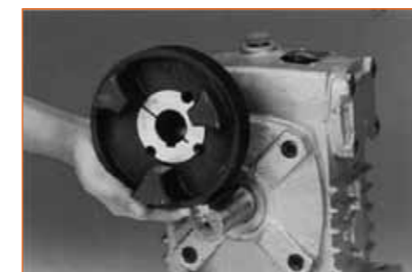
1 - assembler le moyeu
